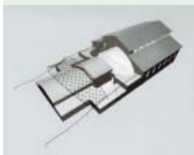
Überdachung fährt auf Schienen in Parkposition
